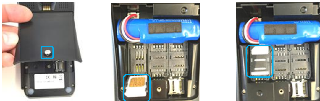
Gehäuseabdeckung öffnen und SIM-Karte einlegen
